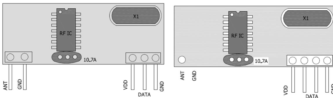
表一 DL-RXP4303 5PIN/4PIN 引脚定义表（出厂默认 4PIN）
