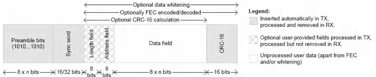
此外，CC2500 支持固定数据包长度、可变数据包长度和无限长数据包长度的传输方式，不同的数据包长度，其配置和控制方式也不一样，详细情况请参阅 CC2500 芯片规格书。
